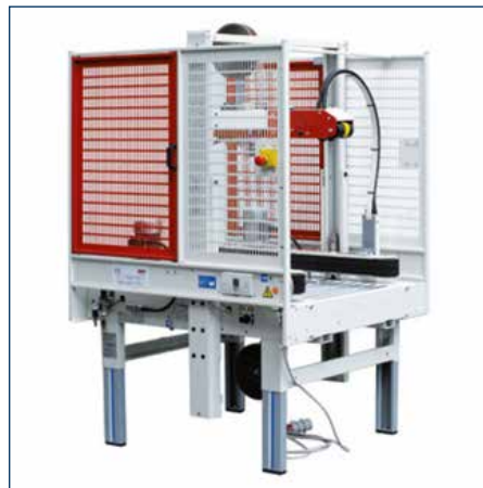
Kartonverschleißer zur weiteren Automatisierung der Packprozesse
