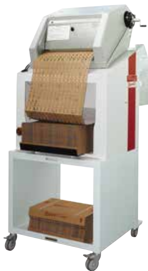
benutzerfreundliche Bedienung: Stapelanfang in die Öffnung einlegen und sofort per Knopfdruck starten
