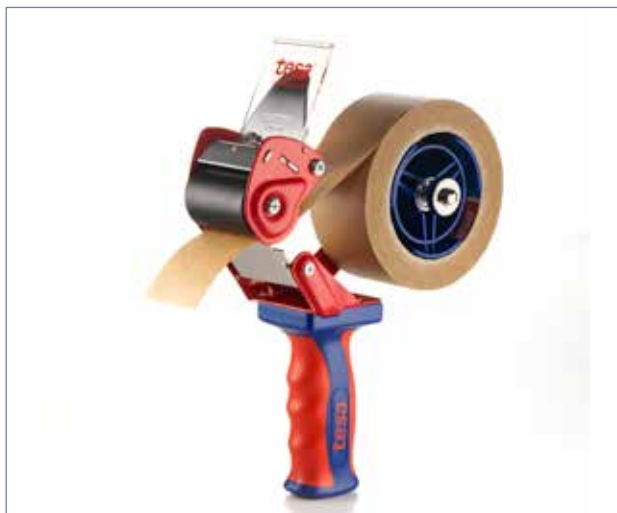
Art.-Nr.: 27446 tesa - stabile Metallausführung, ergonomischer Handgriff mit gummierter Griffzone, variable Bandablaufbremse, aktiver Messerschutz (Touchflap), für Klebebänder mit 76 mm Kern und Rollenlängen von 66 m, 132 m und 180 m geeignet
