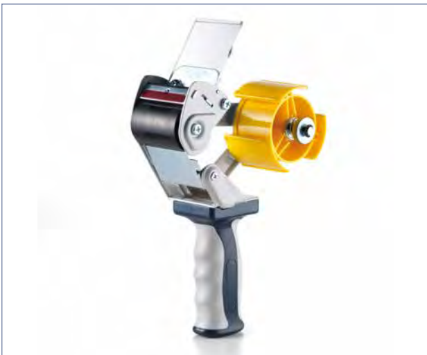
Art.-Nr. 79071 - stabile Metallausführung, ergonomischer Handgriff mit gummierter Griffzone, variable Bandablaufbremse, aktiver Messerschutz (Touchflap), für Klebebänder mit 76 mm Kern und Rollenlängen von 66 m, 132 m und 180 m geeignet
