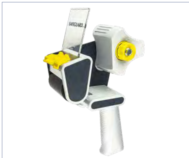
Art.-Nr. 93404 - mit Bremse, Safeguard-Messerschutz, Andruckrolle aus Echtgummi, für Klebebänder mit 76 mm Kern und Rollenlänge von 66 m und für Filament-Klebeband geeignet
